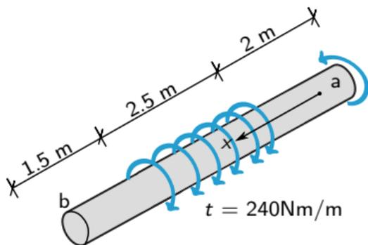
Debido a que el eje se encuentra sometido a un momento distribuido, es necesario integrar el momento distribuido en el largo de aplicación de éste, como es constante se puede simplificar y calcularlo directamente al multiplicar el valor del torsor por la distancia en que este actúa:
